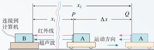
图 1.3-6 位移传感器测速度的原理
