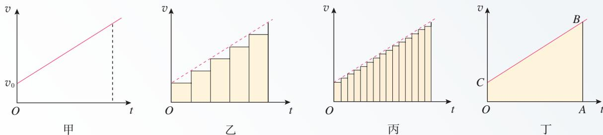
图2.3-4 位移等于  $v-t$  图线下面的面积
