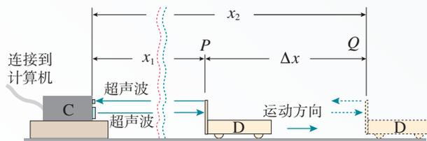
图 1.3-7 另一种位移传感器测速度的原理
