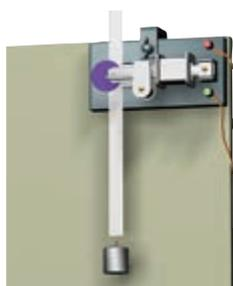
图2.4-2 自由落体运动的实验装置
