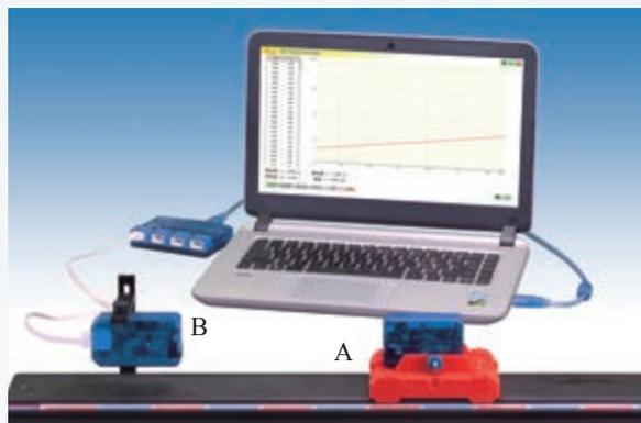
图 1.3-5 实验室用位移传感器测速度的装置
