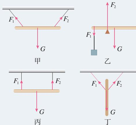
由“问题”栏目中的图示可以看出，图甲和图丁中木棒所受的力是共点力。图乙和图丙中木棒所受的力不是共点力。下面我们来研究物体受共点力平衡的情况。
