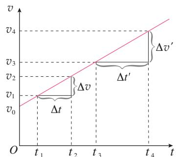
图 2.2-1 匀变速直线运动的  $v-t$  图像
