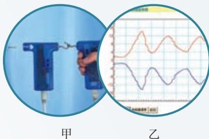
图3.3-6 作用力和反作用力的关系
