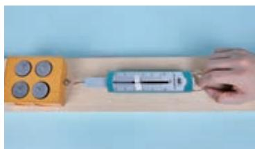
图3.2-4 测量静摩擦力的实验装置
