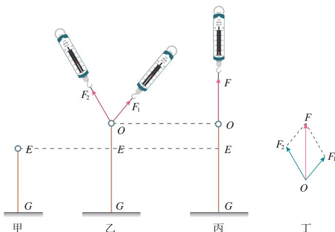
图3.4-3 探究二力合成规律实验示意图
