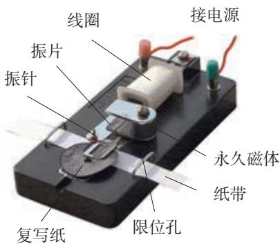
图 1.2-7 电磁打点计时器
