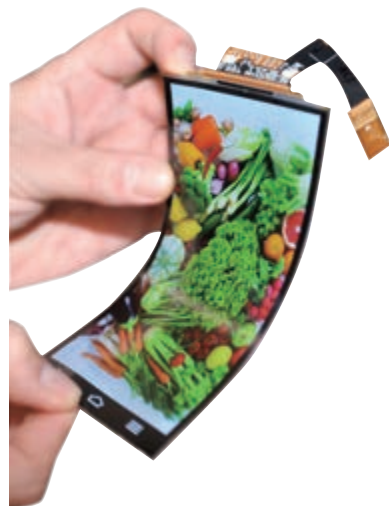
图2 一种利用有机发光材料制造的显示屏
