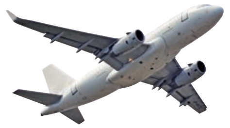
图3-18 硬铝常用于制造飞机的外壳
