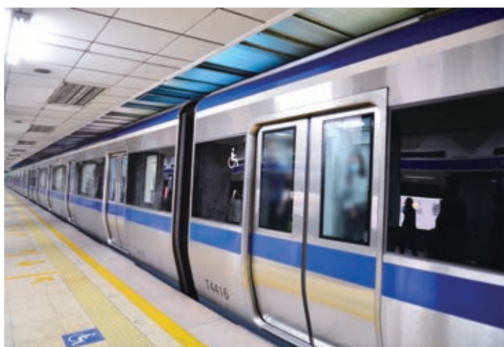
图3-15 用不锈钢制造的地铁列车的车体
