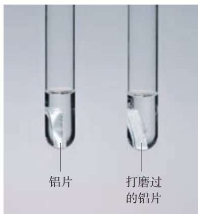
图3-17 将铝片放入NaOH溶液中
