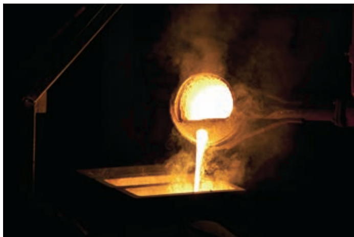
图3-4 钢水注入干燥的模具
